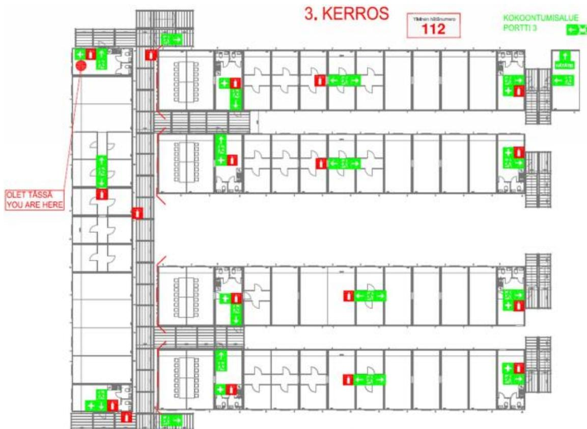
Kuva: Esimerkki piirustus työmaaparakkien poistumisjärjestelyistä
