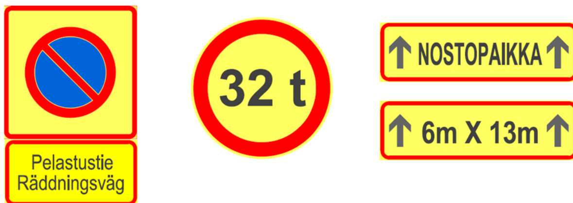
Bild 7. Skyltar för räddningsväg, viktbegränsning, parkeringsförbud i området och lyftplats.
