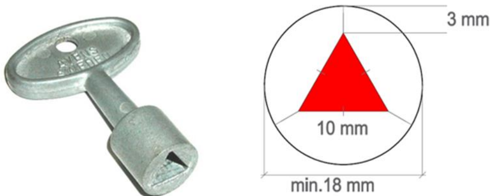
Kuva 8. Kolmioavain, sivut 10 mm sekä kolmioavaimen lukkopesän vaatimukset.
