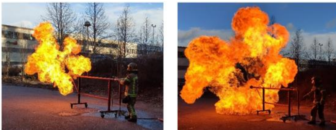
Kuva 4. Vasemmanpuoleisessa kuvassa nestekaasua käytetään kaasumaisessa muodossa. Oikeanpuoleisessa kuvassa nestekaasu otetaan laitteelle nestemäisenä. Kuvaparista näkee, miten tuliefektin luonne ja sen vaatimat turvallisuusjärjestelyt muuttuvat. (Kuvat: Juha-Pekka Koski, Helsingin kaupungin pelastuslaitos)
