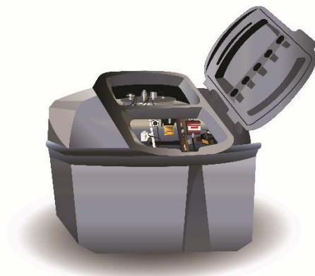
Suuntaa antava piirros avattavasta kaksivaipparakenteesta
