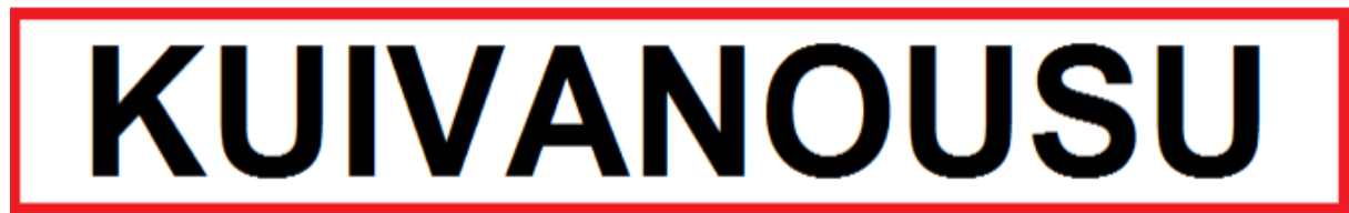
Kuva 9. Syöttöliittimen kotelon kanteen lisättävän kuivanousujärjestelmän vedensyöttöventtiilin merkintä (koko 100 mm x 400 mm).
