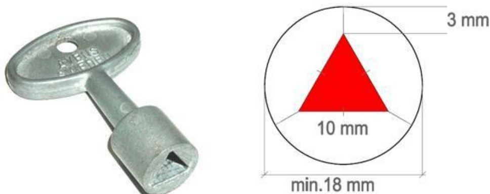
Kuva 8. Kolmioavain, sivut 10 mm sekä kolmioavaimen lukkopesän vaatimukset.
