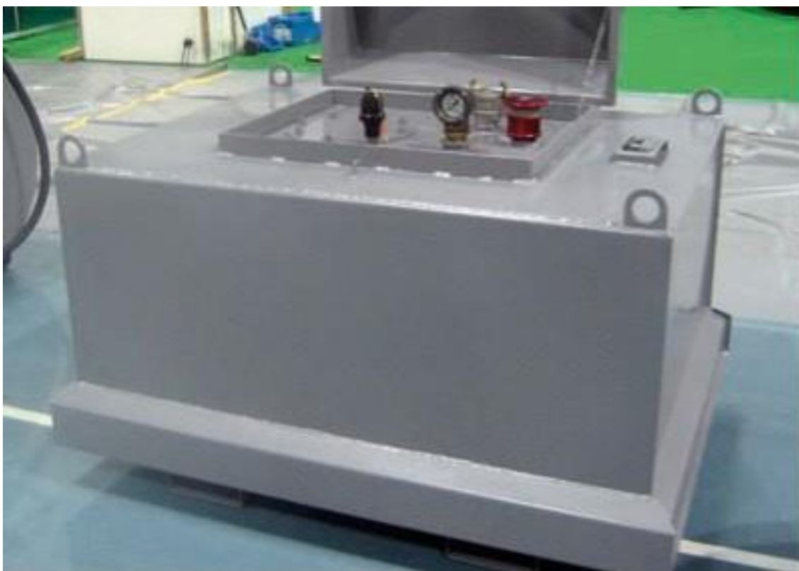
En för lagring och transport godkänd IBC-behållare (volym 1000 liter)
