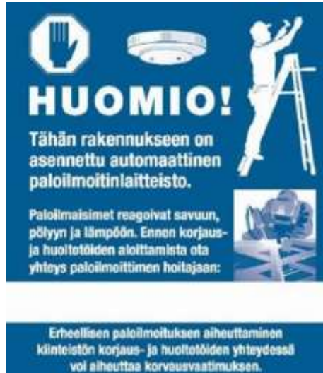
Figur 2. Varningsdekal som informerar om den automatiska brandlarmanläggningen. I den vita rutan skrivs kontaktuppgifterna till den som sköter brandlarmanläggningen.
