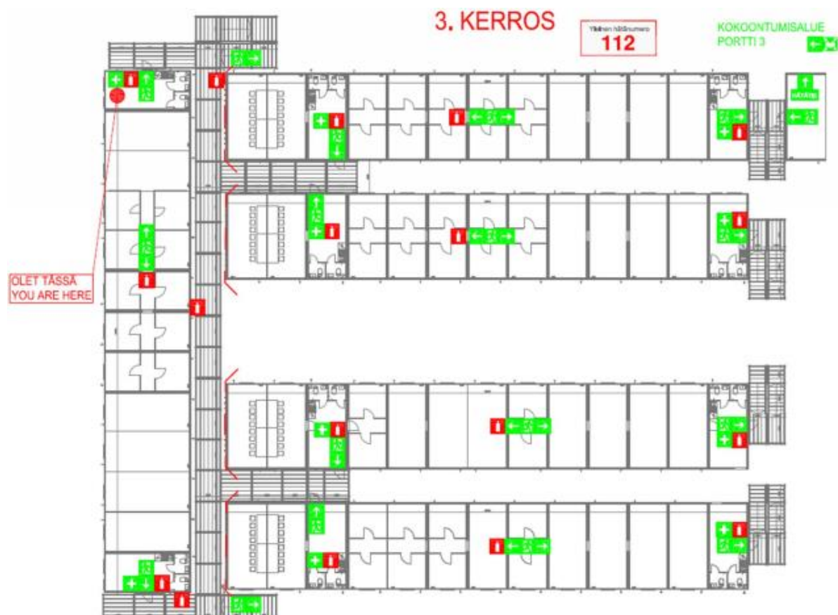
Kuva: Esimerkkipiirustus työmaaparakkien poistumisjärjestelyistä
