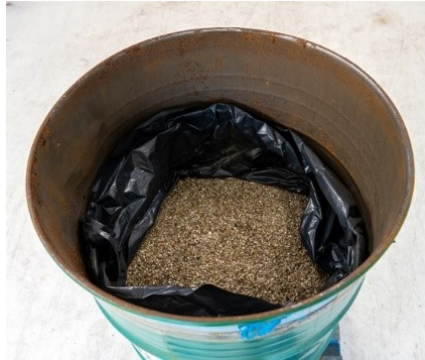
Kuva 3. Tynnyrissä olevaa vermikuliittia akkujen lähetykseen varten.
