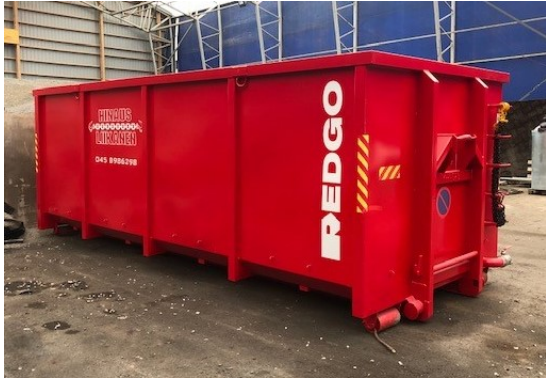
Kuva 9. Vedellä täytettävä autonkuljetuskontti.
