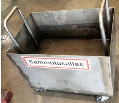
Kuva 2. Pienten akkujen sammutus- ja evakuointi allas.
