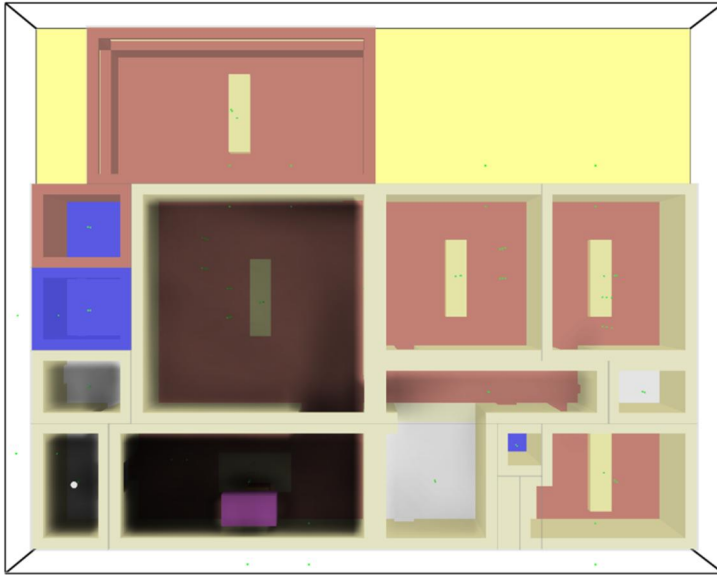
Kuva 46. Visualisointi savun leviämisestä FDS:llä simuloidussa palossa 1,5 minuutin kuluttua palon syttymisestä.
