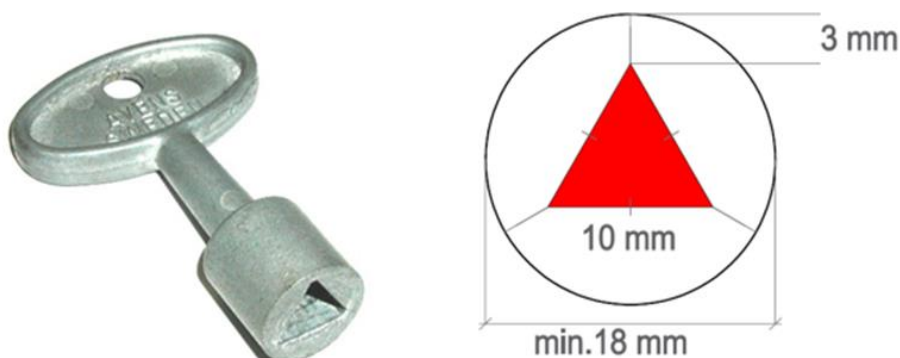
Bild 8. Trekantsnyckel, sidor 10 mm och krav på trekantsnyckelns låskista.
