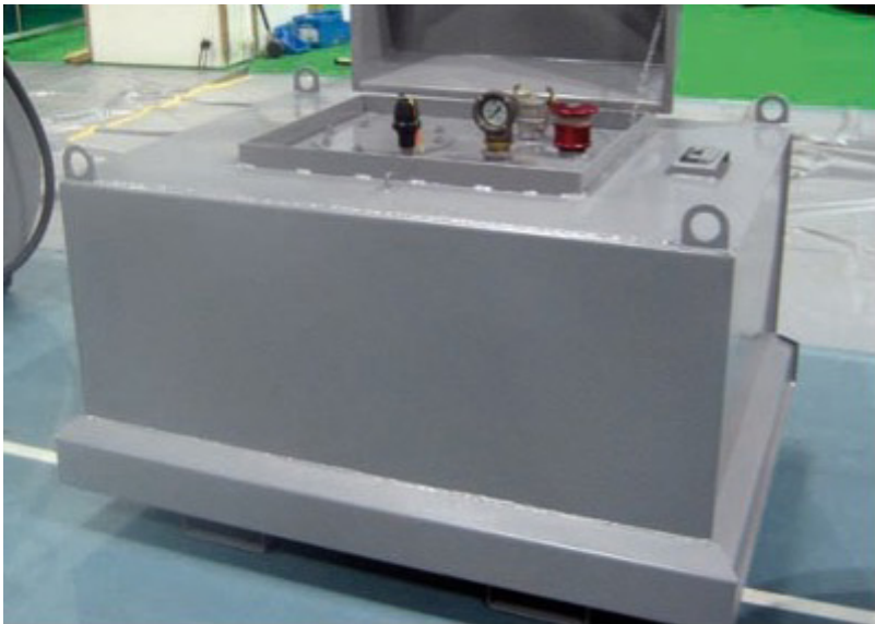
Varastointiin ja kuljetukseen hyväksytty IBC-pakkaus (tilavuus 1000 litraa)
