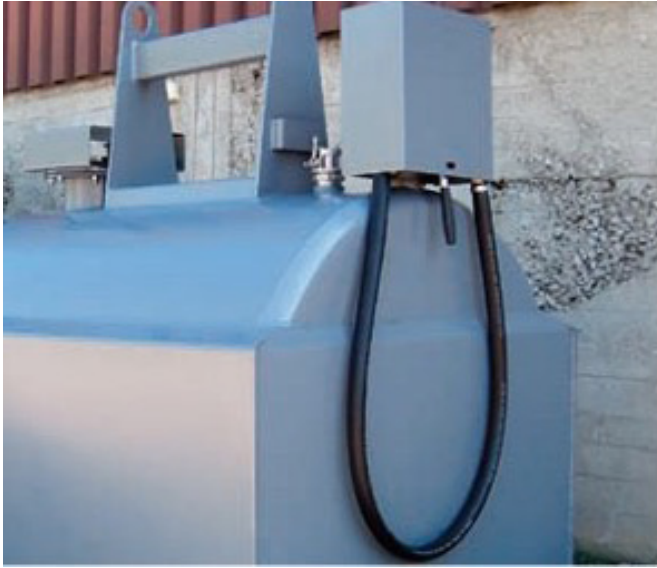
Varastointiin ja kuljetukseen hyväksytty IBC-pakkaus, jossa on nostosanka ja käsipumppu. (Kuva: Pirkanmaan ELY-keskus).
